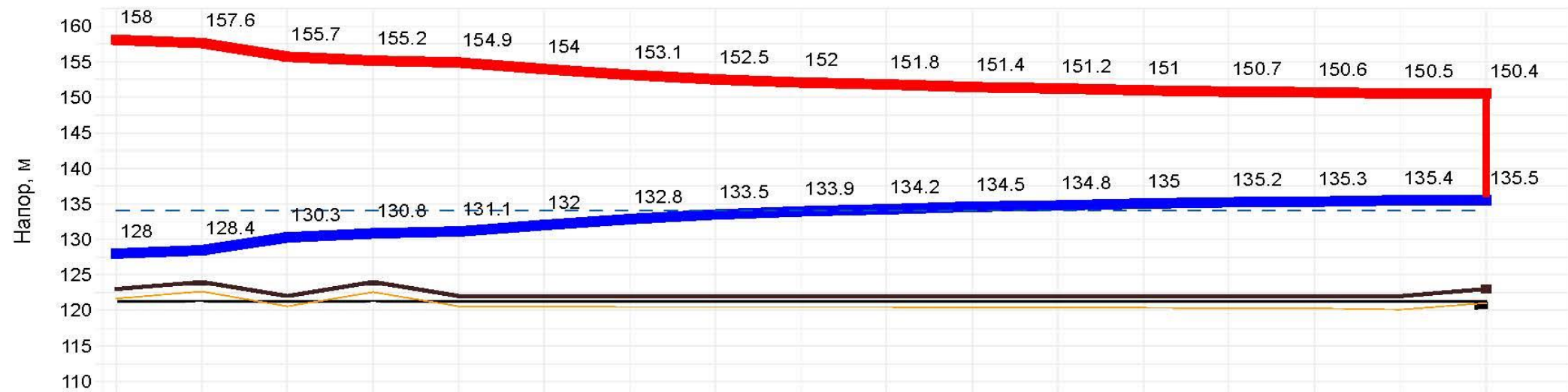
Пьезометрический график от котельной до школы
